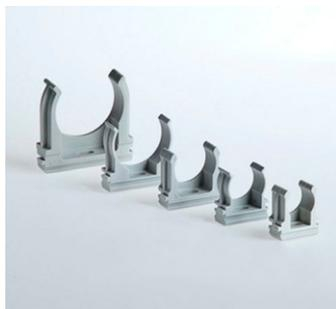
Крепеж гофры изготовлен из качественных материалов по передовым технологиям пластикового литья. Оптимальная форма с рёбрами жесткости обеспечивает надёжный захват трубы. Качественный полипропилен и рёбра жесткости не дают ломаться зажиму на холоде и ослабевать на жаре. Монтаж осуществляется с помощью шурупа (самореза). Для удобства и простоты монтажа боковые крепления, позволяют надёжно крепить зажимы между собой. Материал зажима противостоит масляным и кислым средам, солям и ультрафиолету.
