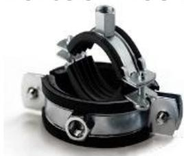
Металлические хомуты применяются для монтажа трубопроводов. Данный вид крепежа имеет внутреннее мягкое резиновое покрытие, предотвращающее повреждение труб при сильном затягивании винтовых стяжек и обеспечивающие снижение уровня шума и вибрации.
