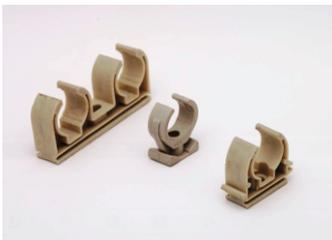
Надёжно фиксирует трубу за счет своей эластичности и конфигурации. Возможна дополнительная фасовка с дюбелем и шурупом. Клипса предназначена для надежной фиксации полипропиленовых труб к поверхности для исключения вибраций и деформаций. Устанавливаются с шагом не более 1 м. для исключения прогибов трубы в местах опор.
